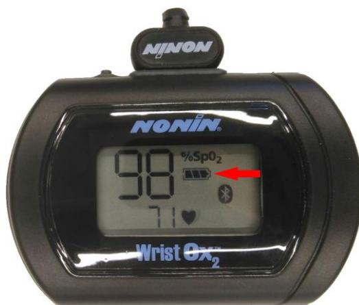
Figura 6 Simbolo di carica della batteria
