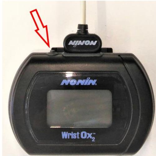
*Abbildung 11 Einschalttaste des Pulsoximeters*
