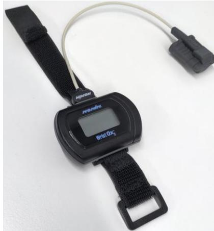
*Figure 2 Oxymètre de pouls et capteur*
