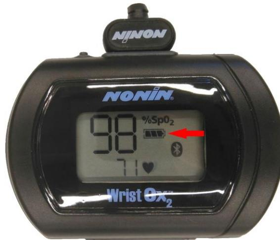
Figure 8 Symbole de charge de la batterie
