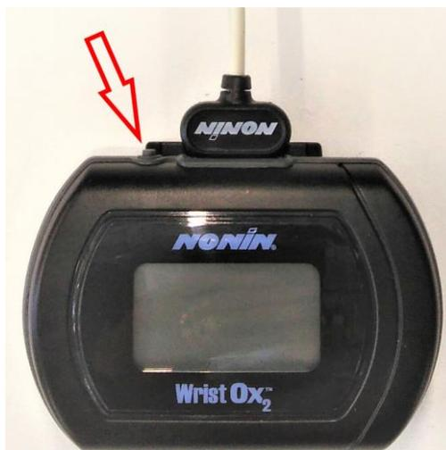
Figure 13 Bouton d'alimentation de l'oxymètre de pouls
