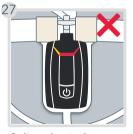
Si l'un des indicateurs LED clignote en rouge ou en **iaune**, vérifiez que l'élément correspondant à l'indicateur est correctement connecté. Les explications relatives aux indicateurs se trouvent à la page suivante.
