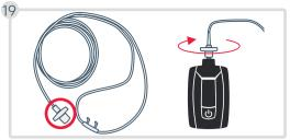
Fixez la canule au Respiro et tournez légèrement le connecteur dans le sens des aiguilles d'une montre jusqu'à ce que vous sentiez au'il se connecte.
