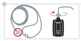
Bringen Sie die Kanüle am Respiro an und drehen Sie den Anschluss leicht im Uhrzeigersinn, bis Sie die Verbindung spüren.
