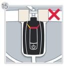
Wenn eine LED-Anzeige rot oder gelb blinkt, überprüfen Sie, ob das entsprechende Gerät richtig angeschlossen ist. Die Erklärungen zu den Anzeigen finden Sie auf der nächsten Seite
