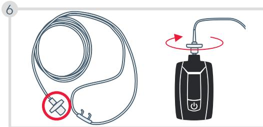
Collegare la cannula a Respiro e ruotare il connettore leggermente in senso orario fino a sentire il collegamento.
