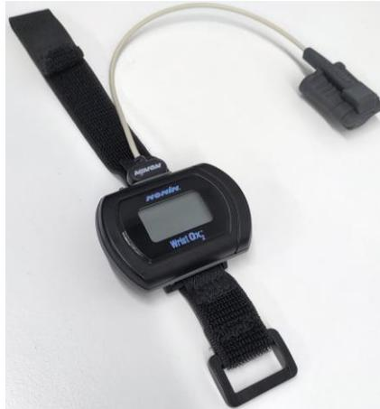
*Abbildung 2 Pulsoximeter und Sensor*
