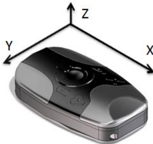
Abbildung 13 Achsrichtungen des Beschleunigungssensors
